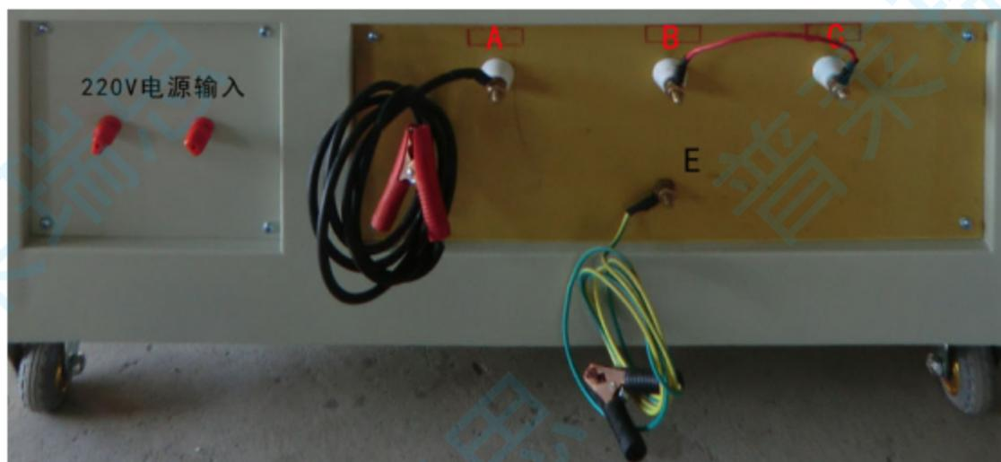
①探伤时，A 点接红夹探伤输出，黑夹 E 点接探伤接地，B、C 短接；
