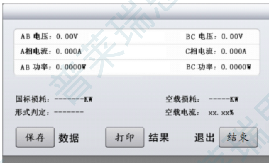
图七 两元件法空载测试
