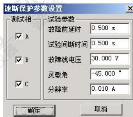
在弹出的对话框中设置其它试验参数。下面以“速断保护”为例进行详细说明，如右图所示：
