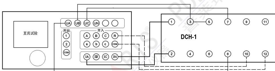
鼠标点击  $U_c$  数值框，直接输入 -110，按回车键），即在第 7 端施加启动电压以启动重合闸，重合闸启动后，等待重合闸时间到，接点动作，即可测出动作时间。
