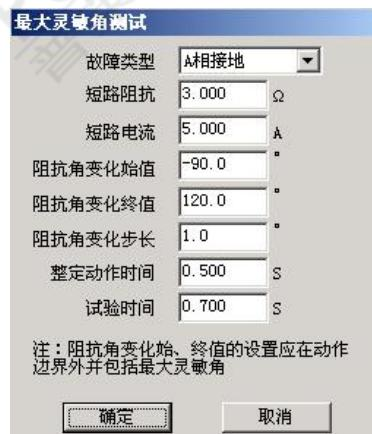
并且给定一个合适的变化步长就可以测出精度符合要求的最大灵敏角。
