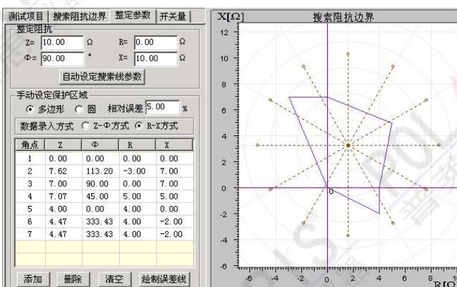
**绘制圆** 在上图中选择“圆”特性，在下面的表格中设置“整定阻抗”、“阻抗角度”以及“偏移量”等参数。右图中将实时显示其图形。用鼠标选中图形的中心，并在“搜索阻抗边界”页面中设置足够大的搜索半径及相应步长。如右图所示。
