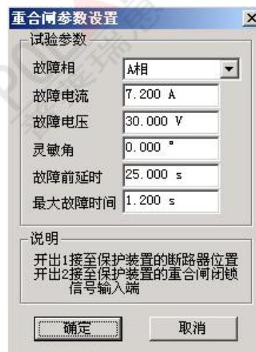
满之前重合闸处于闭锁状态，此时任何故障只跳闸不重合。重合闸充电时间一般在 15—25 秒左右。
