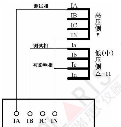
Y侧相位调整, 无零序修正, 按单相短路接线
